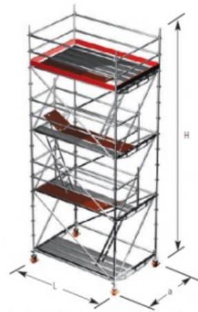
Parámetros de autoestabilidad: [a] y [H], siendo a < L .
