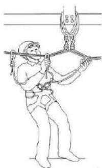
Figura 4: Progresión horizontal sobre una estructura utilizando tres cabos de anclaje
