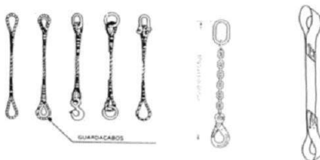
Figura 1: Diferentes tipos de eslingas
