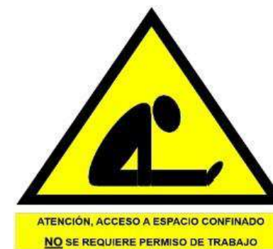
SEÑALIZACIÓN ESPACIOS CONFINADOS TIPO II (AMARILLOS - NO REQUIERE PERMISO DE TRABAJO)
